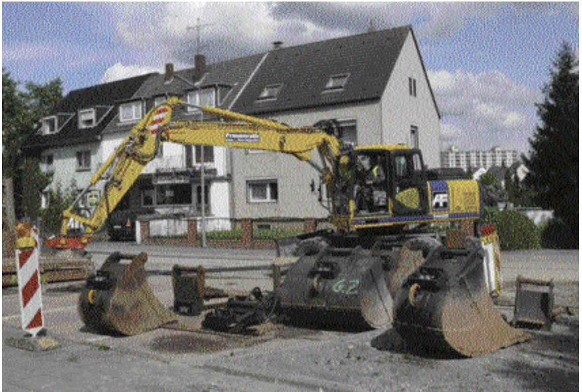
Je nach Einsatzanforderung kann mit Leihhoff Variolock das Anbaugerät in Sekundenschnelle gewechselt werden – und zwar sowohl die mechanische Verbindung als auch die hydraulischen Anschlüsse, ohne dass der Fahrer die Kabine verlassen muss. (Foto: Leihhoff Hartstahl)
