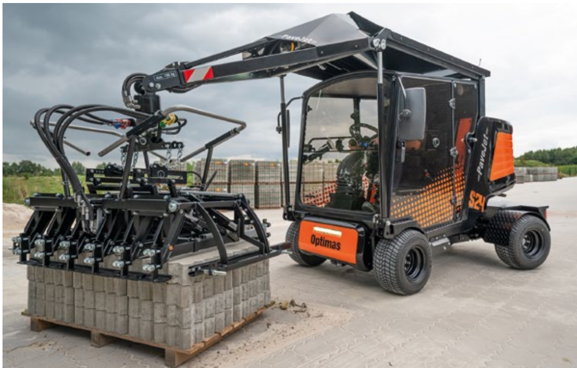
Die neue Optimas Pflasterverlegemaschine PaveJet S24 hat einen leistungsstarken Kubota Motor und ist mit nur 1.980 mm Höhe Tiefgaragen tauglich. (Foto: Optimas GmbH)
