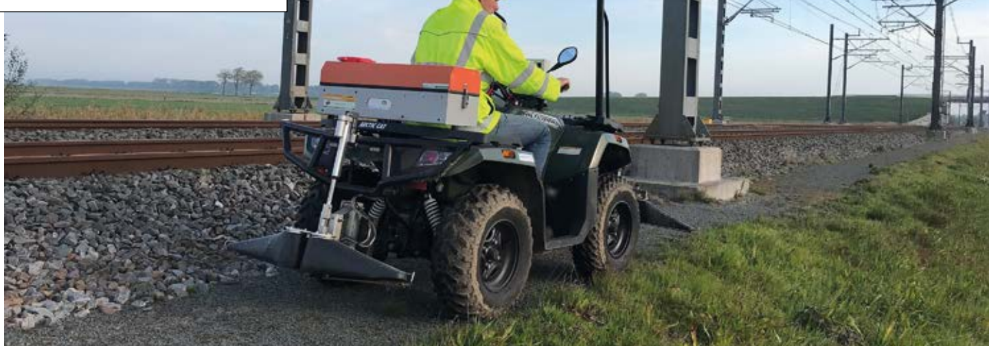
MANKAR®: Präzise ULV-Technologie für reduzierten Mittelverbrauch. (Foto: MANTIS ULV Sprühgeräte GmbH)
