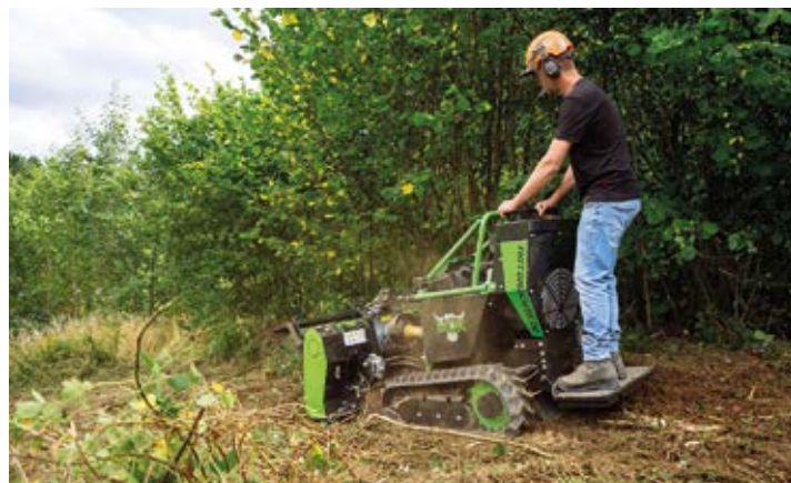
MOX mit Forstmulcher, der auch als Forstfräse & Steinbrecher nutzbar ist.
