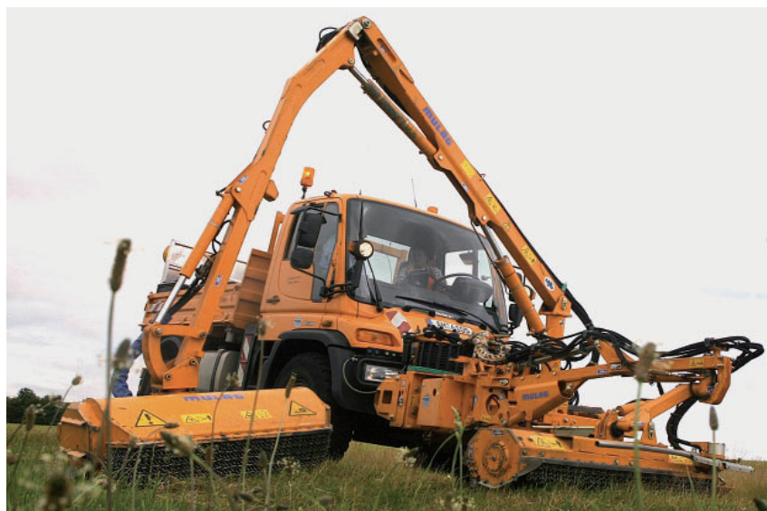
Bild 2: Unimog U 400 mit Randstreifen- und Böschungsmähgerät
